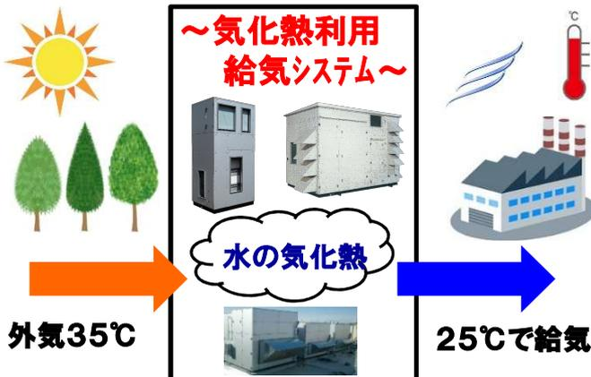
【水の気化熱を活用した給気システム】
