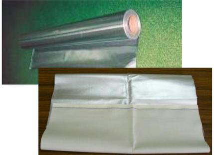
この特殊遮熱シートは、アルミ純度99%を使用した最大5層構造で、**輻射熱を97%反射**する。厚さも0.2mm～と超薄型を実現。熱源へ貼り付けることで熱源から出ている放熱を抑制(遮熱)し、保温を行う。保温を行うことで熱源の温度が保ちやすくなる為、省エネに繋がり、さらに生産性アップにも寄与する。断熱材の場合、伝導熱を伝え、放熱してしまうが、本遮熱シートでは熱を遮熱することで効果的な保温が可能となる。**遮熱シートも用途に合わせて種類を選べ、加工することも可能です。**
